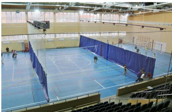
**Система деления зала вертикальная** с электроприводом предназначена для деления спортивного зала или иного помещения на отдельные тренировочные или игровые зоны. Опускание и подъём полотна осуществляется автоматически при помощи электропривода. Цвет сетки и диаметр ее ячеек может быть разнообразным, в зависимости от ваших пожеланий. Сетка прекрасно пропускает солнечный свет во все зоны зала, но в то же время, не пропускает мелкие спортивные снаряды, например, теннисные мячики.
