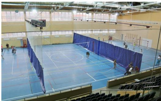
**Система деления зала** вертикальная с ручным приводом предназначена для деления спортивного зала или иного помещения на отдельные тренировочные или игровые зоны. Опускание и подъём полотна осуществляется оператором. Цвет сетки и диаметр ее ячеек может быть разнообразным, в зависимости от ваших пожеланий. Сетка прекрасно пропускает солнечный свет во все зоны зала, но в то же время, не пропускает мелкие спортивные снаряды, например, теннисные мячики.
