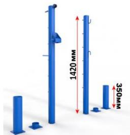
Стойки для большого тенниса устанавливаются преимущественно на открытых площадках. Изготовлены из стальной трубы, наружный диаметр 76 мм, с толщиной стенки 3,5 мм. Высота стоек 1420 мм. Высота стаканов 350 мм.
