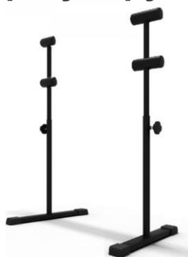
Хореографический станок мобильный двухрядный с регулируемой высотой представляет собой сборную конструкцию, состоящую из стойки кронштейна, передвижного держателя поручня и опорного основания изготовленных из стали. Сварные швы хореографических стоек тщательно обработаны и зачищены. Поверхность покрыта порошковой краской. В комплекте с кронштейнами идут саморезы для крепления жерди.
