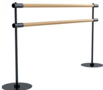
**Хореографический станок мобильный двухрядный Рондо** представляет собой сборную конструкцию, состоящую из стойки кронштейна с держателями поручня изготовленных из стальной трубы и опорного основания изготовленного из стального листа. Сварные швы хореографических стоек тщательно обработаны и зачищены. Поверхность покрыта порошковой краской цвета муар. В комплекте с кронштейнами идут саморезы для крепления жерди. **Поручни в комплект поставки не входят и приобретаются отдельно.**
