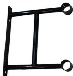
Хореографический станок-кронштейн настенный двухрядный представляет собой цельносварную конструкцию, состоящую из кронштейна, держателей поручней и опорного основания изготовленных из стали. Сварные швы хореографических кронштейнов тщательно обработаны и зачищены. Поверхность покрыта порошковой краской. В комплекте с кронштейном идут саморезы для крепления жерди.
