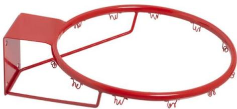
Кольцо баскетбольное №7 ТР Эконом представляет собой сварную конструкцию, состоящую из: кольца и крепежной пластины с 4-мя отверстиями, усиленной подпорками. Изготовлено из стальной трубы диаметром 16 мм., диаметр кольца 450 мм., 12 крючков -"барашков" для крепления сетки. Присоединительный размер под болты: 100x110 мм. Вся конструкция покрыта порошковой краской. Поставляется без сетки и крепежа.
