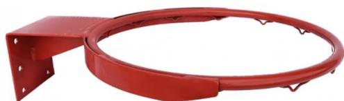
**Кольцо баскетбольное №7 ТР усиленное** представляет собой цельносварную конструкцию, состоящую из кольца (труба), усилительной полосы, крючков и опорного основания изготовленных из стали. Сварные швы колец баскетбольных тщательно обработаны и зачищены. Поверхность покрыта порошковой краской. В комплекте с кольцом идут болты и гайки для крепления к щиту баскетбольному.
