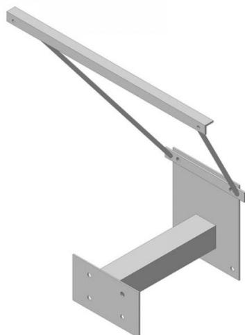
Ферма предназначена для крепления к стене тренировочного баскетбольного щита. Изготовлена из стального профиля сечением 60x60мм покрытого полимерной краской белого цвета. Ферма комплектуется трапецией которая обеспечивает дополнительный диагональный крепеж, позволяющий снизить и распределить нагрузки на щит возникающие во время игр и тренировок.
