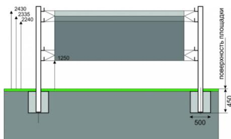
**Стойки волейбольные уличные бетонируемые D76 mm.**, предназначены для проведения тренировок или соревнований по волейболу.
