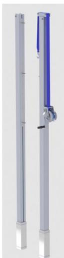
**Стойки волейбольные со стаканами из алюминиевого профиля 80x80** представляют собой конструкцию из алюминиевого профиля 80x80 мм. с лебедкой, натяжной планкой и сварными металлическими стаканами 96x96 мм., закрываемыми металлическими заглушками. Стойки устанавливаются в стаканы, забетонированные в землю.
