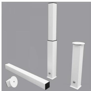
Комплект стаканов применяется для установки и фиксации свободностоящих ворот изготовленных из квадратного алюминиевого профиля 80x80 мм., чтобы предотвратить опрокидывание. **Стаканы для ворот из алюминиевого профиля 80x80** бетонируются в грунт или пол с последующей вставкой закладных и установкой на них ворот. В комплекте со **стаканами** идут металлические заглушки, которые защищают от попадания мусора в стакан. В **стакане** предусмотрен ограничитель для закладной на случай попадания мусора.
