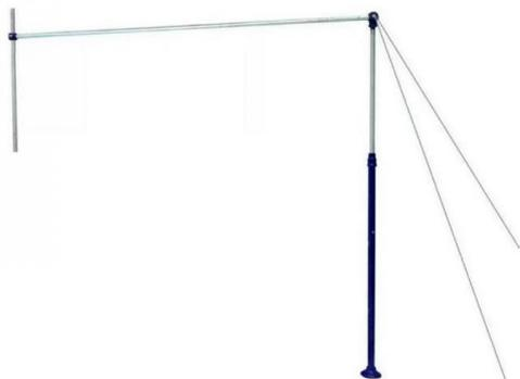
Перекладина гимнастическая пристенная (ГО-17) представляет собой металлическую конструкцию, состоящую из стержня с двумя растяжками, вертикальной стойки телескопического соединения и сборочного узла для крепления к стене. Одна стойка при помощи растяжек крепится к полу, другая анкерными болтами к стене. Перекладина применяется для разных возрастных категорий занимающихся за счет широкого диапазона регулировки по высоте.
